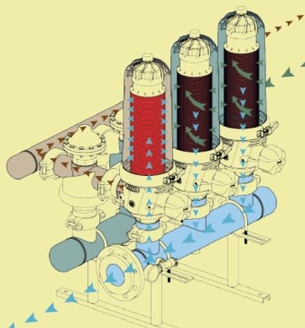
**ETAPE DE FILTRATION:** L'eau entrant dans le filtre se traverse avec l'hélice provoquant un mouvement hélicoïdal centrifuge, qui éloigne les particules des disques.
